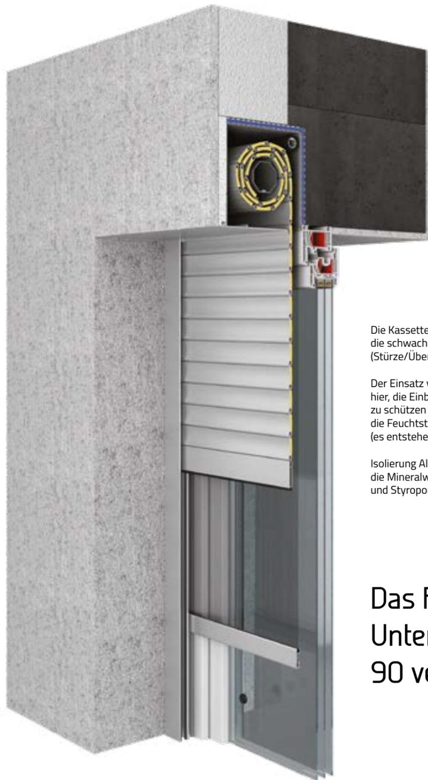
Die Kassetten der Rollläden werden an kritischen Stellen, die schwach gegen Durchfrieren geschützt sind (Stürze/Überlager).
