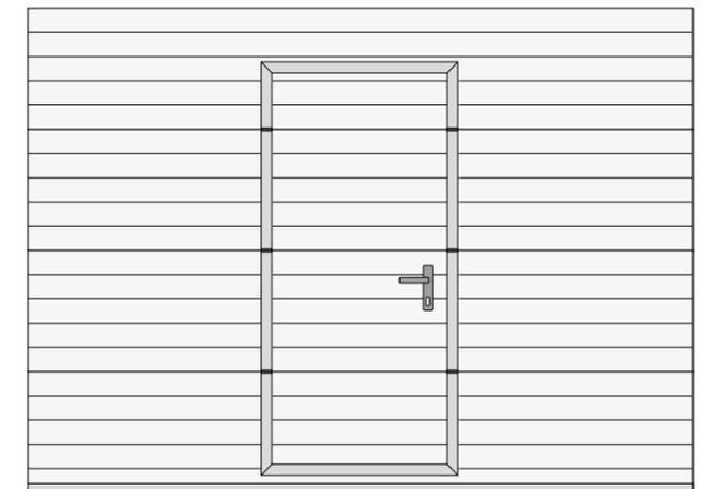
Tor mit integrierter Tür 900 x 2 000 mm; Für Tore mit einer Breite bis 4 500 mm; Minimale Torhöhe 2 250 mm
