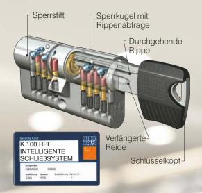
Vielseitig und sicher - heute und in Zukunft. keyTec RPE von Winkhaus ist das innovative System für die einzelgesicherte Schließung. Ein neuartiger Kopierschutz gibt Ihnen die Gewissheit, dass nur befugte Personen einen Nachschlüssel anfertigen können. Dies wird erreicht durch eine speziell ausgeprägte Rippe am Schlüssel, die im Schließzylinder durch eine Sperrkugel abgefragt wird.
